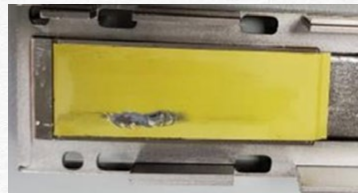
保持架/散热器上的导热垫损坏
